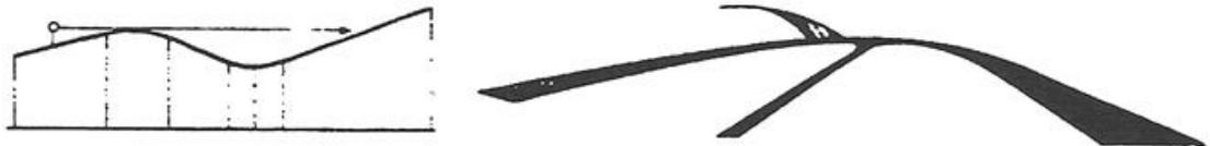
figura 1.105. Mau traçado em perfil (perda do traçado)
