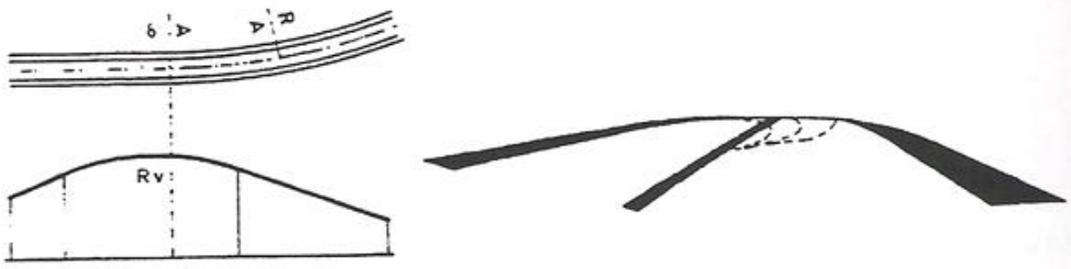
figura 1.106. Início da curva circular após concordância convexa, o que impede ver a mudança de direção em planta
