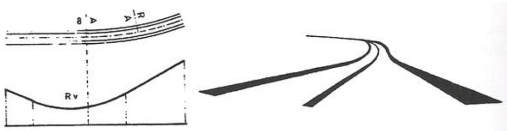
figura 1.107. Início de curva circular após uma concordância côncava, provocando uma quebra do traçado
