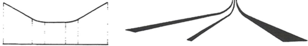
figura 1.104. Mau traçado em perfil (pequeno tranelo entre duas concordâncias côncavas)
